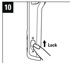
Sie können das Gerät wieder verriegeln, indem Sie den Schalter nach oben schieben.
