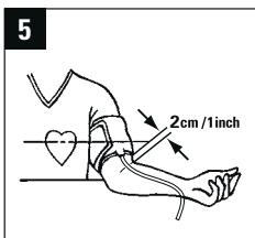
Legen Sie die Manschette so an, dass sie ca. 2 cm oberhalb der Armbuge sitzt. Lagern Sie den Arm ausgestreckt, so dass die Manschette sich in Brusthöhe befindet.
