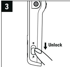
Entriegeln Sie das Gerät, indem Sie den Schalter an der Seite nach unten schieben.
